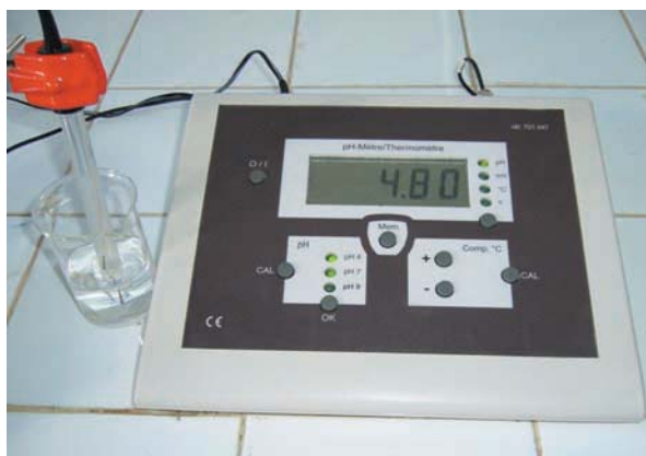
Figure 1. Mesure du pH d'un mélange d'acide éthanóique et de soude.
