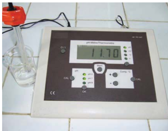
Figure 3. pH d'une solution d'hydroxyde de sodium 5.10^{-3} M.
