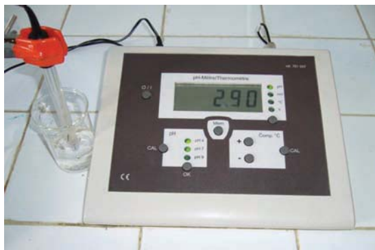
Figure 3. Mesure du pH d'une solution aqueuse d'acide méthanoïque
