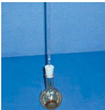
Figure 5. Déplacement d'équilibre par effet de la variation de la température à pression constante.
