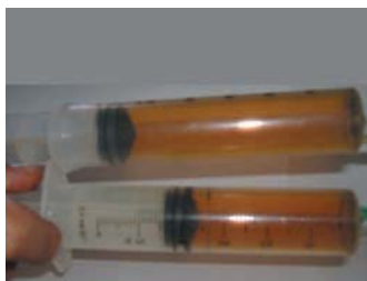
Figure 2. Mise en évidence de l'effet de la variation de la pression à température constante sur un système fermé initialement en équilibre dynamique.
