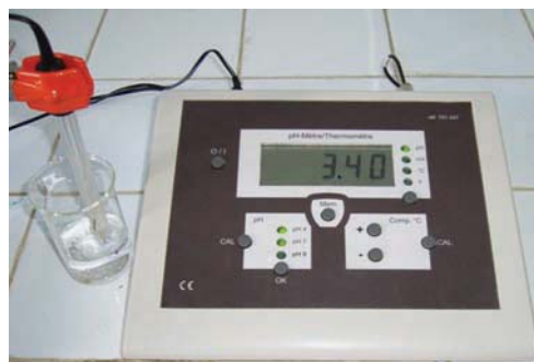
Figure2. Mesure du pH d'une solution aqueuse d'acide éthanoïque
