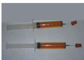
Figure 2. Mise en évidence de l'effet de la variation de la pression à température constante sur un système fermé initialement en équilibre dynamique.
