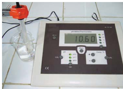
Figure 5. Mesure du pH d'une solution aqueuse d'ammoniac
