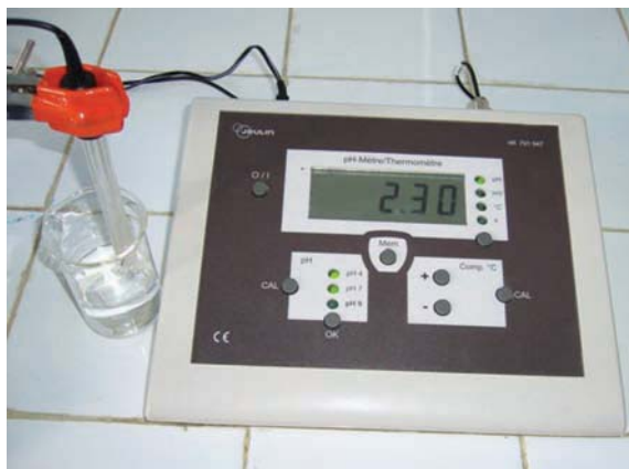
Figure 2. pH d'une solution de chlorure d'hydrogène 5.10^{-3} M.
