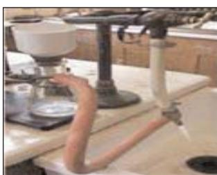
Figure 3. Filtration avec un dispositif Büchner.
