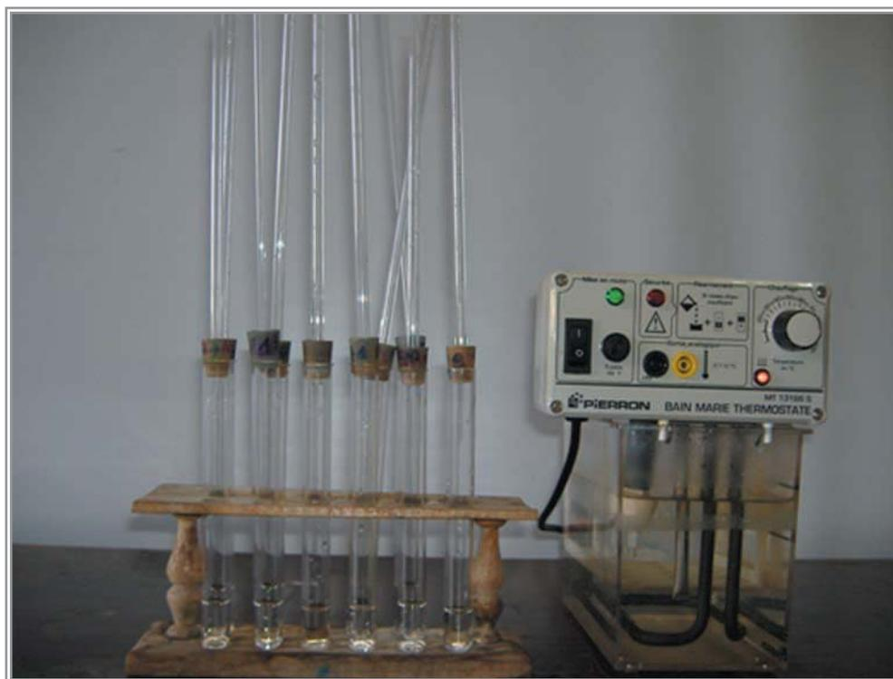
Nous avons vu que pour chaque système contenant au départ un acide et un alcool ou un ester et de l'eau, en présence d'un catalyseur approprié et à la température de  $80^{\circ}\text{C}$ , il se produit à notre échelle soit une estérification spontanée pour le premier système, soit une hydrolyse spontanée pour le second.
