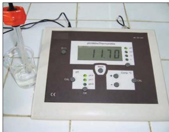
**Figure 3.** pH d'une solution d'hydroxyde de sodium  $5 \cdot 10^{-3}$  M.
