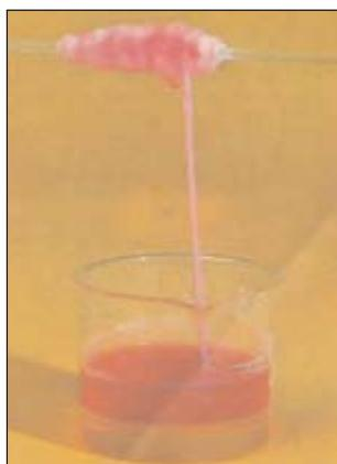
**Figure 2.** Le nylon fabriqué est coloré par de la phénolphtaléine.
