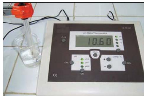
Figure 5. Mesure du pH d'une solution aqueuse d'ammoniac.
