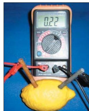
Figure 1. Pile au citron.
